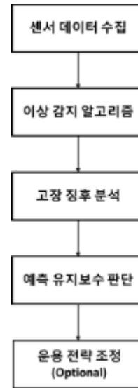
그림 3. 실시간 상태 모니터링 및 유지보수 예측 흐름도 Fig. 3. Flowchart for Real-time Monitoring and Predictive Maintenance
