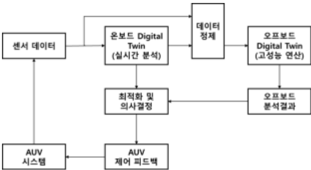
그림 2. AUV 운용을 위한 디지털 트윈 프레임워크 개념도 Fig. 2. Conceptual Framework of Digital Twin for AUV Operations
