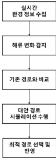
그림 4. 자율운항 최적화를 위한 환경 적응 경로 재계획 흐름도 Fig. 4. Conceptual Flowchart of Adaptive Path Replanning for Autonomous Operation
