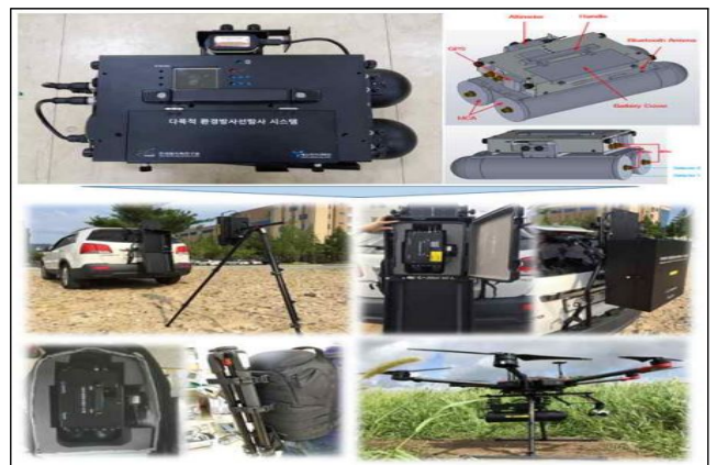
그림 8. 다목적 환경 방사선 탐지시스템 19)
